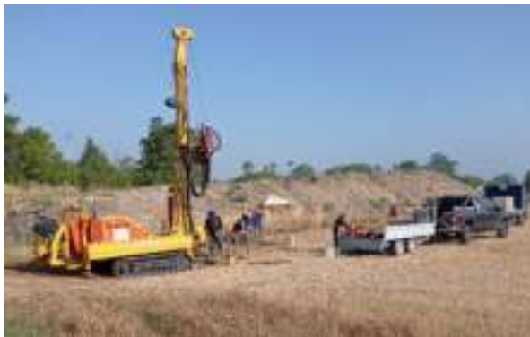
מקדח מעמיק לאדמת הביצה לבדיקת קרקע לקראת הכנת התשתיות לשכונה החדשה. ראו גם בשער העיתון.
